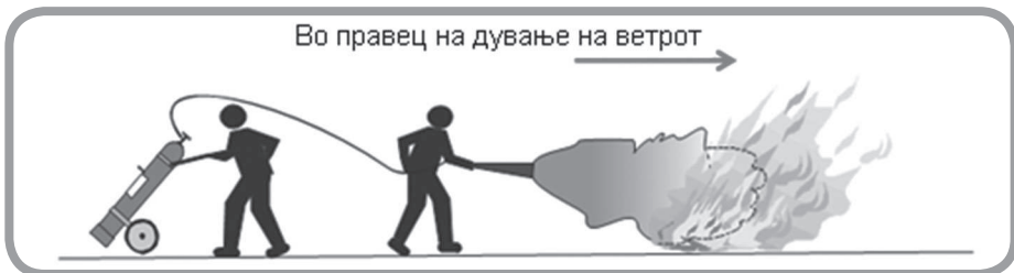
Слика 6.13. Гаснење пожар со превозен ПП-апарат од типот „ \text{CO}_2 “-10 kg
