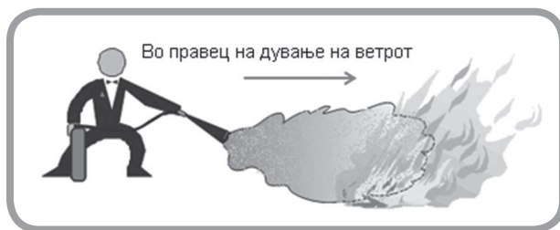
Слика 6.11. Гаснење со ПП-апарат од типот „CO 2 “-5 kg
